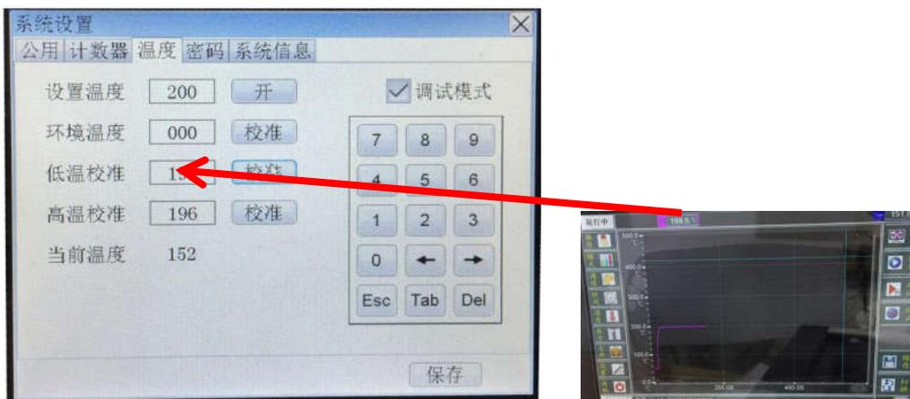
4、高温校准：以校准 500 度温度为例，点击“高温校准”后面的值，待温度测试仪上显示的数值稳定后，手动在“高温校准”值中输入温度测试仪显示的相对稳定的数值，点击校准。如下图
