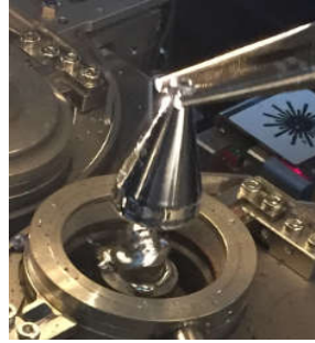
(2) 尖嘴鉗夾住噴咀，移動至垂直錫波上方，使噴咀底部多餘的錫塊融化。
