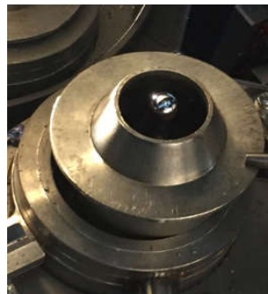
(6) 安裝氮氣保護罩
