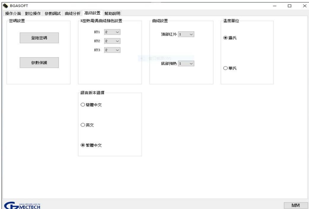
1. 高級設置：在該界面中可以對操作許可權、通訊、視頻等進行設置，還可設置預熱閥門值、溫度曲線的顏色和線寬，以及有簡體中文、英文、繁體中文三種語言可供選擇。
