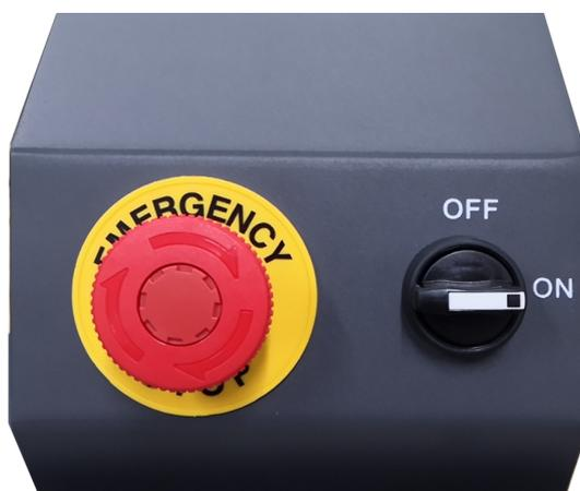
急停開關：當機台發生故障時，按下此按鈕用於切斷運動機構電源。
