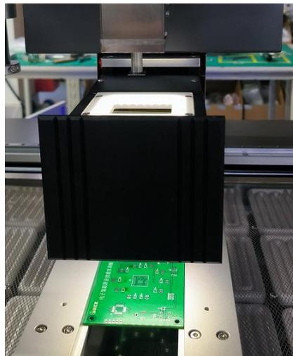
④吸取晶片後，對位稜鏡自動伸出，調整圖像到一定大小，然後調節清晰度，使上模組和下模組圖像同時清晰呈現在視頻上，按照下圖來判斷是否需要進行校準。
