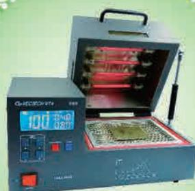
974 IR 热辐射回焊植球机
