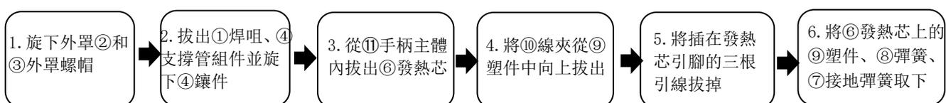
△注意：所有操作步驟都是在切斷電源、手柄冷卻狀態下進行。
