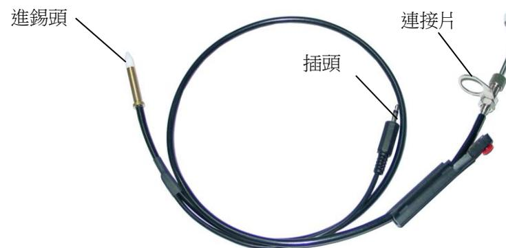
將出錫導管元件的進錫頭插入機器上蓋的出錫引導管（先應旋松其固定螺絲），旋緊固定螺絲。插入插頭至機器正面的開關插孔，如果使用腳踏開關則將腳踏開關的插頭插入此插孔。
