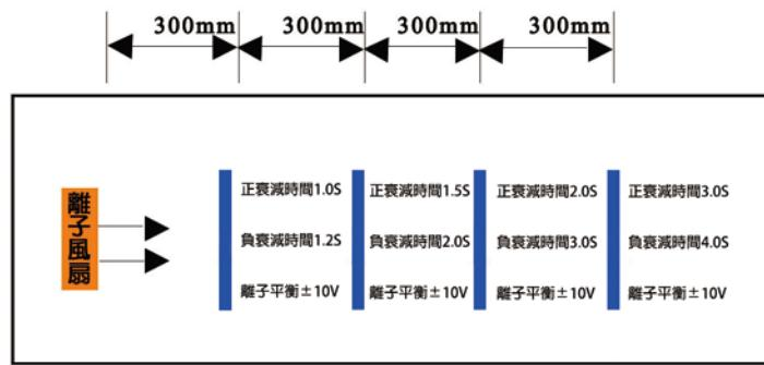
**注** 測試條件：大風量 ( $\approx 4.6 \text{ m}^3/\text{min}$ ) 22±2°C 45±5%RH
