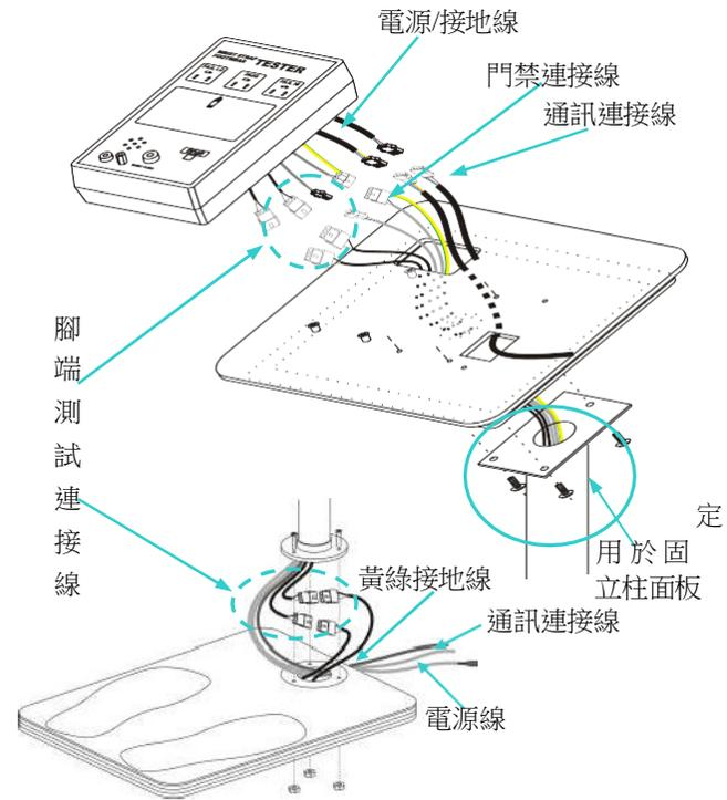
6. **固定立柱：**底部連接線連接好後，取出包裝裡的三隻 6x25 內六角螺絲，按照圖示將立柱固定在立柱底板上，旋緊螺絲。
