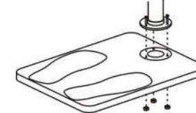
7. **固定立柱面板：**頂部連接線接好後，利用立柱面板附帶的三個螺絲、螺母將立柱面板固定在立柱上。然後將測試儀固定在立柱面板上：測試儀背面底板有三個孔，立柱面板左側有三個螺絲，用於將測試儀掛靠在立柱面板上。
